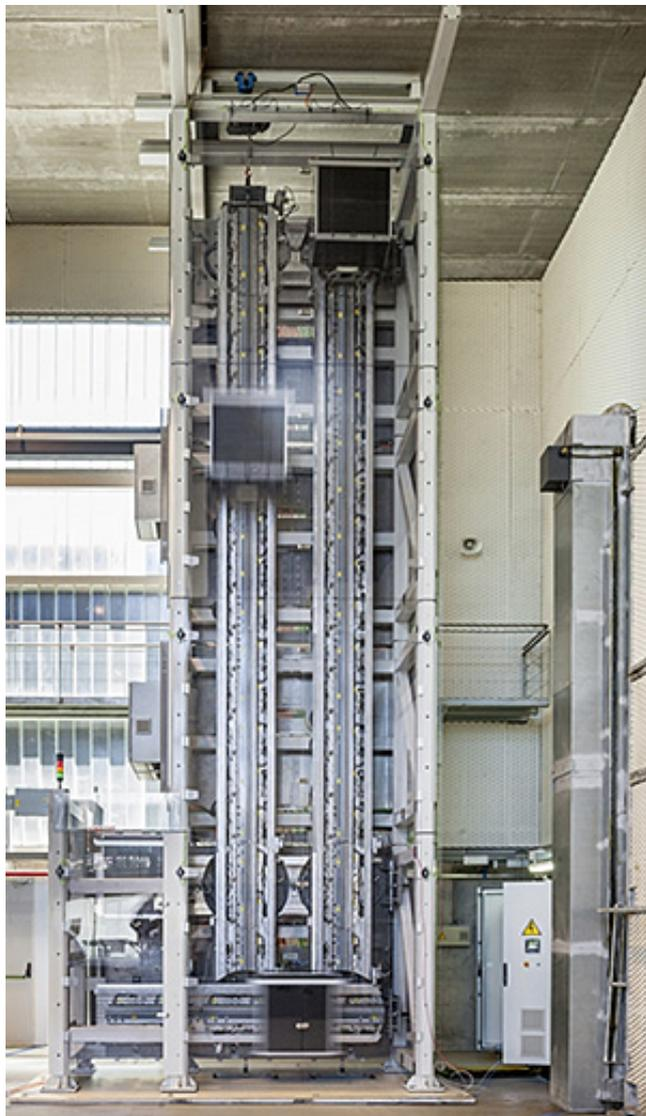
Com quatro cabinas e dois poços de 10 metros, modelo em escala reduzida acaba de entrar em operação no Centro de Inovação de Gijón, na Espanha. Primeiro protótipo, em tamanho real, está previsto para testes em final de 2016
