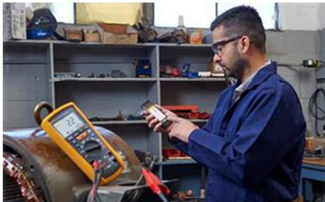
O Fluke 1587 FC reúne a capacidade de um testador digital de isolamento e de um multímetro digital True RMS em uma mesma unidade compacta e portátil, que proporciona o máximo de versatilidade para identificação e solução de problemas e manutenção preventiva
