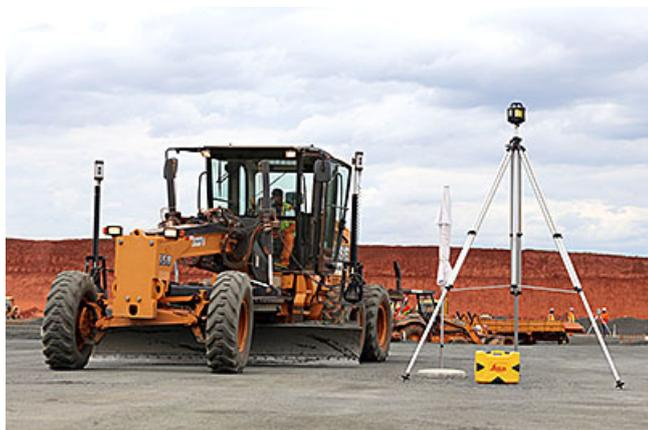
Obra da empresa de celulose Klabin, realizada com o uso do aplicativo 'SiteControl' em motoniveladoras, trator de esteiras e escavadeiras hidráulicas, comprova redução significativa de gastos e aumento da produtividade nos canteiros de obras
