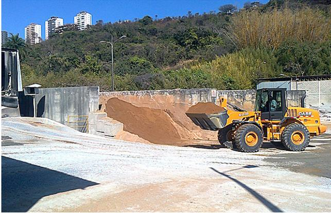
Má utilização da máquina pode comprometer todo o processo de uma central produtora. A pá carregadeira é um equipamento essencial para a indústria do concreto. Sua função principal é o abastecimento das caixas ou balanças de agregados (como areia e brita), além do seu empilhamento nas baias onde o concreto é produzido. Como esse trabalho é realizado no início do processo de produção, a boa utilização da máquina garante melhor rendimento em toda a atividade de carregamento na central de produção.
