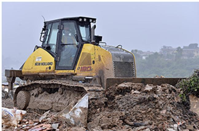
Destaque para o trator de esteiras D180C, que tem peso operacional adequado para o serviço de compactação. Escavadeiras hidráulicas também são muito utilizadas pela força na movimentação e carregamento de materiais
