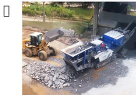
*Os bons resultados da operação contínua já geraram novos negócios* O britador móvel MR 110 Z EVO da Kleemann em operação na Votorantim Cimentos, em Sorocaba (SP), está chamando a atenção pelo desempenho alcançado. Utilizado na britagem, fase inicial do processo de fabricação de cimento, em substituição a britadores fixos, o equipamento móvel está atendendo à demanda da fábrica e sem necessidade de parada da planta devido à rapidez de instalação proporcionada pela mobilidade.
