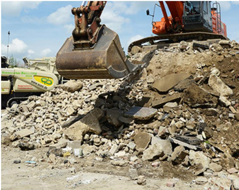
**Britador móvel e flexível permite operação combinada de britagem e de reciclagem de concreto e asfalto**
