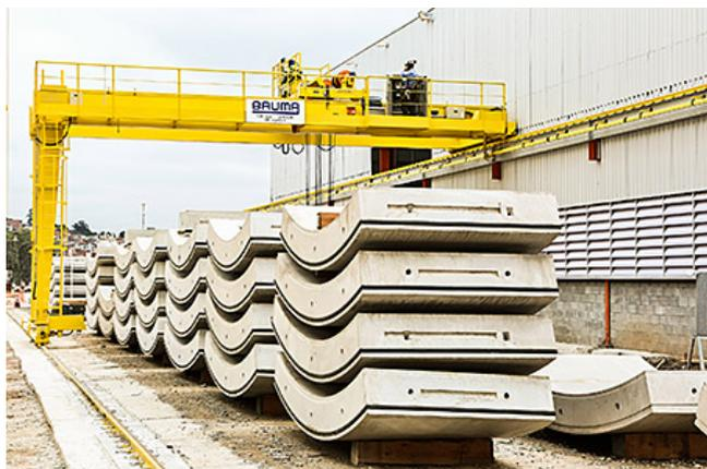
Mais de 300 funcionários produzirão 7,3 mil anéis de concreto, usados para revestir os 13 km de túnel da linha
