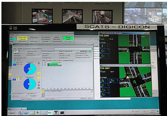
Inicialmente, a implantação do primeiro SCATS (Sistema de Controle Adaptativo de Trânsito em tempo real), desenvolvido pela Digicon, ocorrerá em quatro cruzamentos da Rodovia RS-453, que dá acesso à Caxias do Sul/RS. A solução permite alterar automaticamente os tempos de verde dos semáforos conforme a aproximação de veículos dos cruzamentos por meio de detectores virtuais com câmeras de vídeo.
