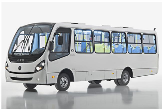
Novos modelos têm carroceria Solum com chassis Volksbus 9.160 OD
