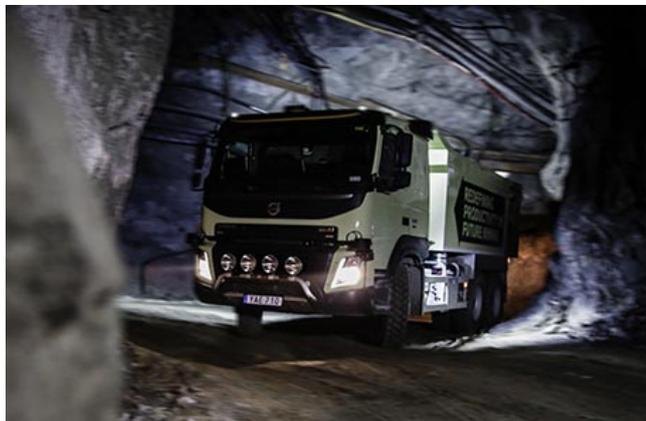
Um Volvo FMX totalmente autônomo é o primeiro caminhão do mundo a ser testado em operações subterrâneas, na Mina de Kristineberg, no norte da Suécia. O caminhão autônomo é parte de um projeto para o desenvolvimento de tecnologias que visam aprimorar o fluxo de transporte e a segurança em minas. O modelo percorre um trajeto de sete quilômetros, alcançando uma profundidade de 1.320 metros nos estreitos túneis da mina.
